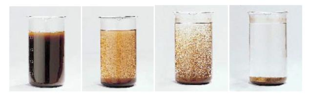
Huminsäurensalze werden besonders vorteilhaft in Kombination mit herkömmlichen Flockmitteln angewendet. Diese hydrolysieren in der Regel zu Säuren, die durch die zugegebene Huminsäurensalzlösung neutralisiert werden. Dabei bildet sich eine sehr stabile kombinierte Flockung aus, die sich effektiv sedimentieren oder filtrieren lässt.
