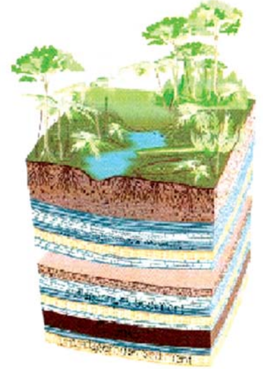
الشكل رقم 2 : رسم تخطيطي لعملية تقمخ المخلفات النباتية في الطبيعة (مخلفات نباتية - بتموس - ليونارديت - ليغنيت)
